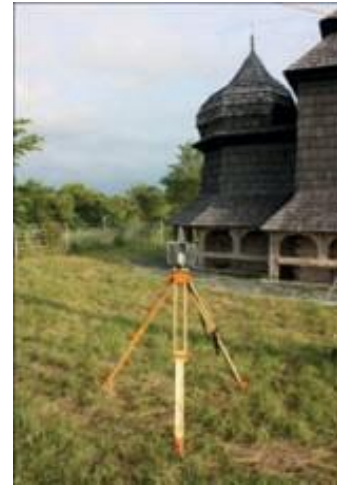
Fig. 7. Комп'ютерна модель дерев'яної церкви Пр. Богородиці у с. Великополе Яворівського району. Процес сканування церкви. Source: https:// geoterrace.lpnu.ua/
